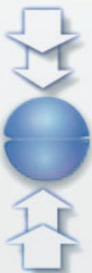
En el proceso de contracción el cartucho expansible vuelve a su estado inicial facilitando su fácil extracción del orificio, con las consecuentes ventajas como no tener que volver a agujerear el molde, no tener que destruir la resistencia, facilita la limpieza del molde, reutilizar la resistencia en otras ubicaciones, reducir stock al tener un mismo diámetro para distintos agujeros etc.
