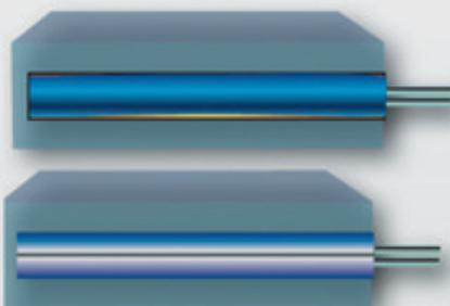
Las longitudes largas, no se arquearan, que es el principal problema de los cartuchos convencionales gracias a la forma de los tubos, que hacen la función de reforzar longitudinalmente la estructura del cartucho Expan, facilitando su extracción. Al expandirse por igual por todo el perímetro, la transmisión de calor será uniforme sin crear curvaturas que produzcan cavidades que se sobrecalienten produciendo la rotura de la resistencia.
